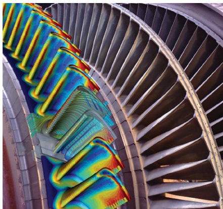
Transfert thermique conjugué d'une aube de turbine refroidie.
